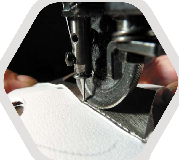
Steppen des Schuhoberteils Stitching of the upper
